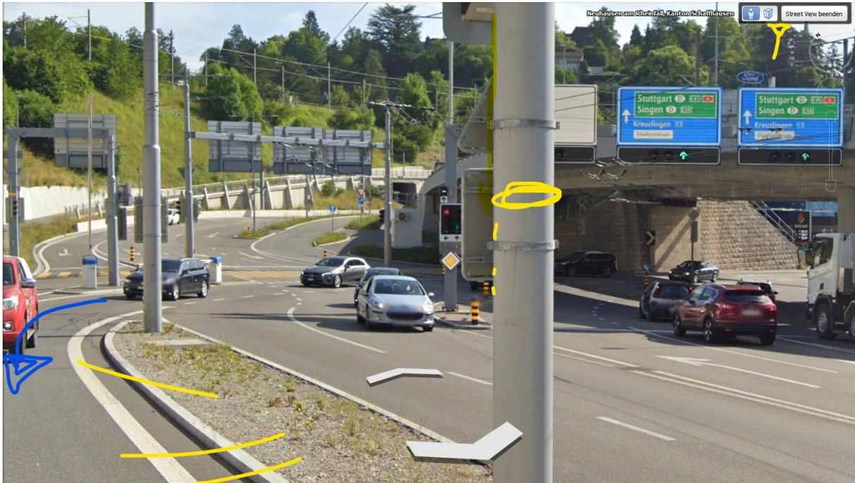
Vom Sender auf dem Parkhaus erfolgt hier am Mast eine weitere Reflexion
