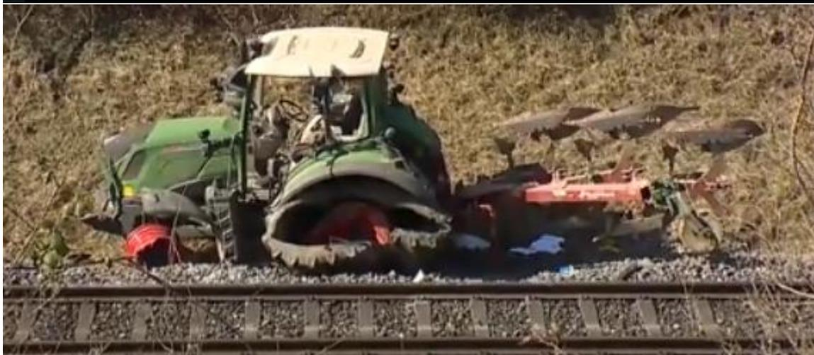
Bei einer Arbeitsrichtung nach Westen hätte er eine seitlichen Rolle gemacht und wäre in der gleichen Richtung nach einer Rotation nach links massiv in der jetzigen Position gelandet. Dies erklärt auch die starke Deformation der linken Räder.
