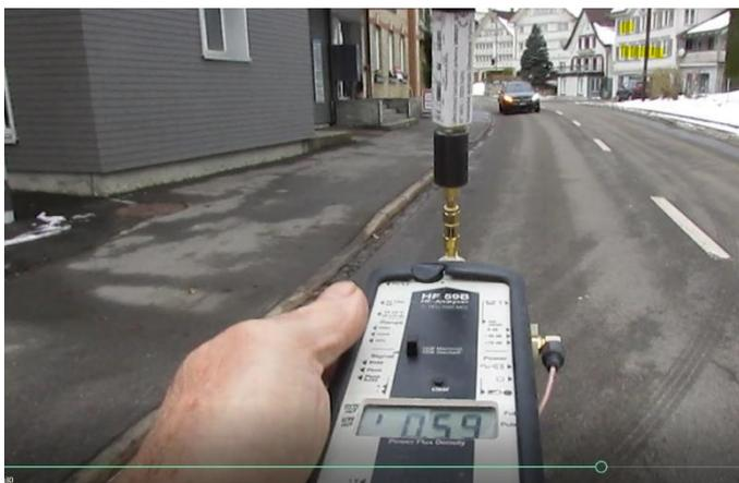
Die Omnidirektionale Messung holt die verschiedenen Reflexionsmomente umfassender ab als die direktionale Antenne.
