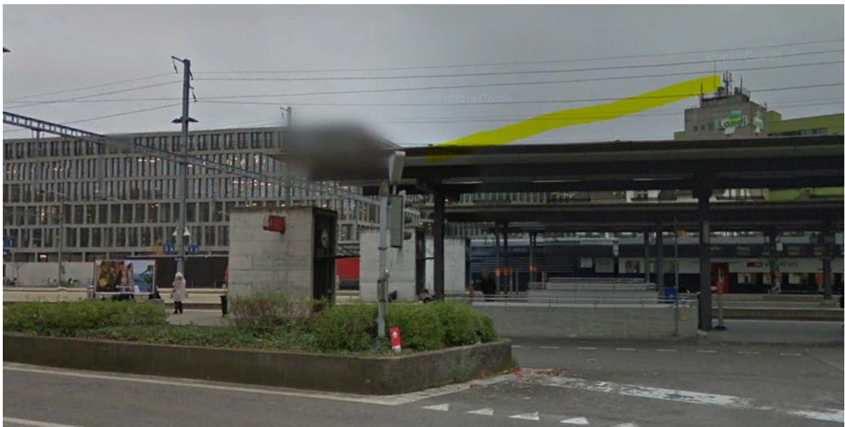
Der Sender vom Landi-Silo erreicht wegen der hohen Querverbindung der Campus-Gebäude den nahen Kreisverkehr wie unten dargestellt nicht
