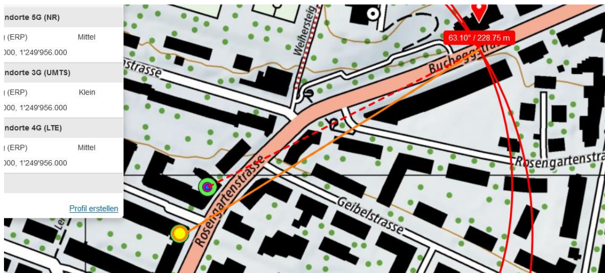
Der zweite Sender erreicht die Passage via Reflexion an den Glasfassaden: 15m und oben ca. 5m
